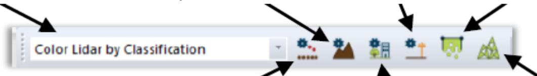
A função de remoção de ruído detecta e reclassifica pontos de ruído numa nuvem de pontos.
